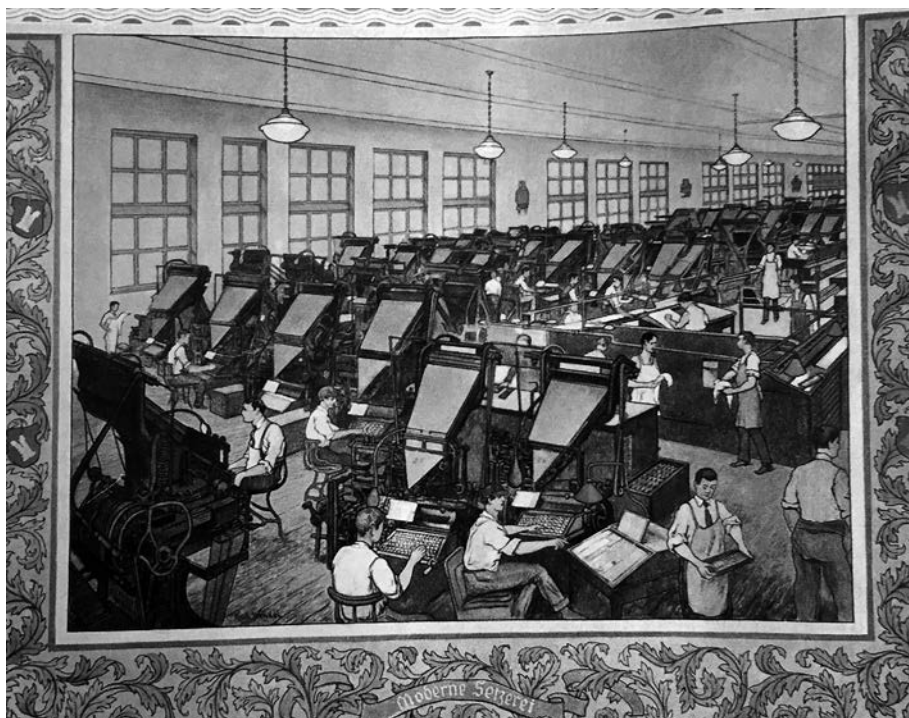
Bild 1 u. 2 Die Linotype: Die mechanisierte Setzmaschine als Grundlage für den Zeitungsboom. Broschüre der Mergenthaler Setzmaschinen-Fabrik Berlin, ca. 1927.
